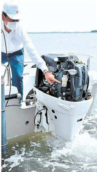
スズキが開発した船外機用の海洋プラスチック回収装置＝6日午前、湖西市のスズキマリーナ浜名湖
