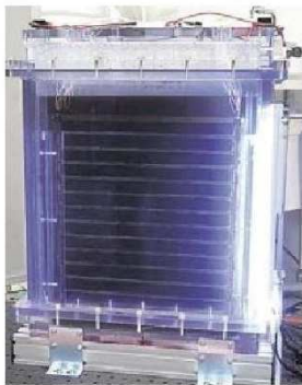
人工光合成の効率を世界最高水準まで高めることに成功した、豊田中央研究所の「人工光合成セル」=21日午後、愛知県長久手市
